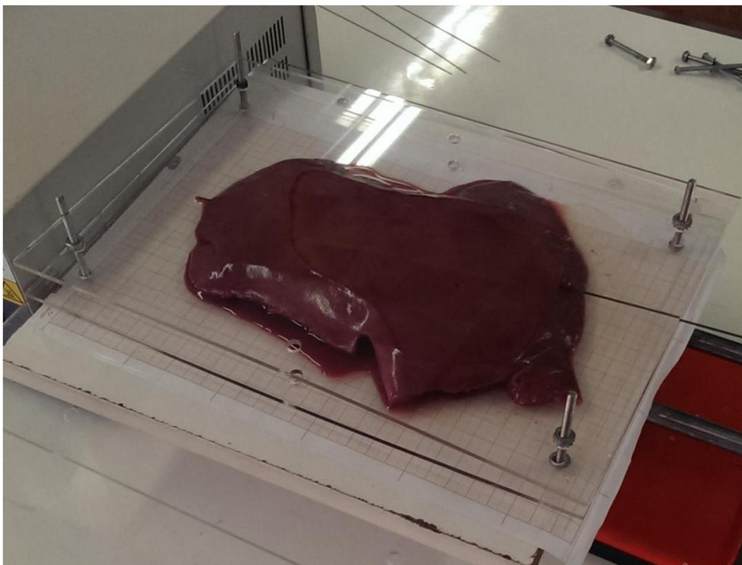
Figura 4.10 – Fígado de porco pressionado entre duas placas de acrílico por parafusos
