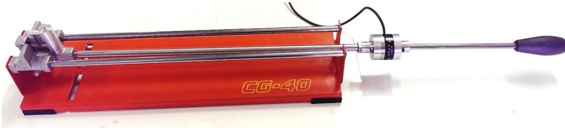
Figura 4.4 – Dispositivo montado com célula de carga.
