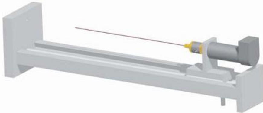
Fig. 2.15 – Dispositivo de guiagem de agulha por suporte telescópico. A bainha telescópica foi omitida da figura (Webster, 2005).
