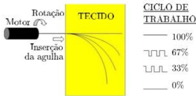
Figura 2.13 – Método dos ciclos de trabalho e as diferentes curvaturas obtidas para diferentes ciclos de trabalho (Engh et al, 2006).
