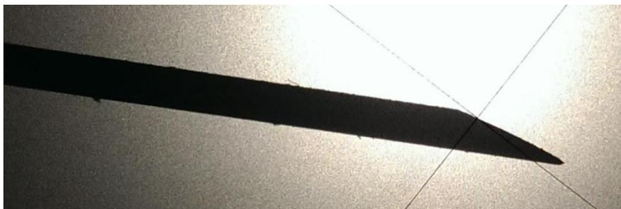
Figura 4.6 – Ilustração da medição de ângulos no projetor de perfil.
