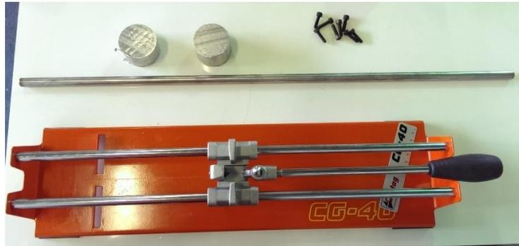
Figura 3.2 – Material para adaptação do cortador de placas cerâmicas.
