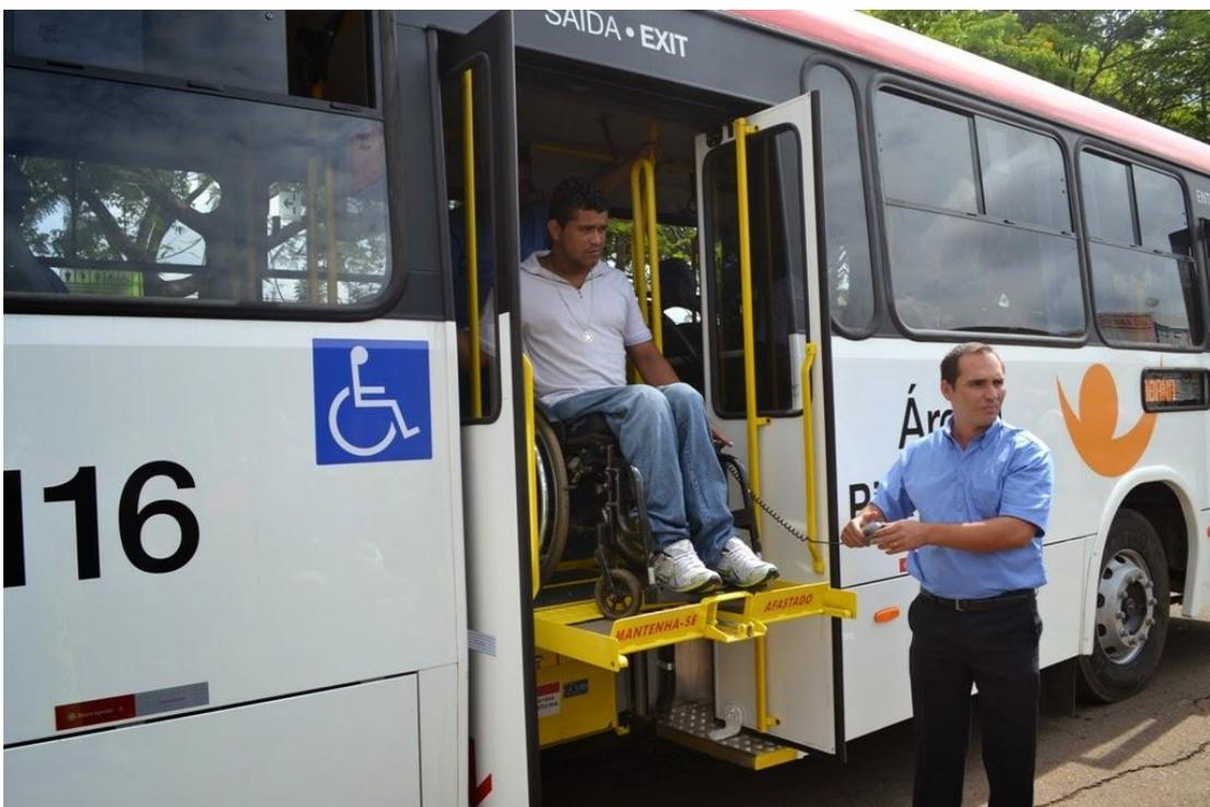
Figura 27: Ônibus com rampa para pessoa com mobilidade reduzida. Fonte: Internet/2015
