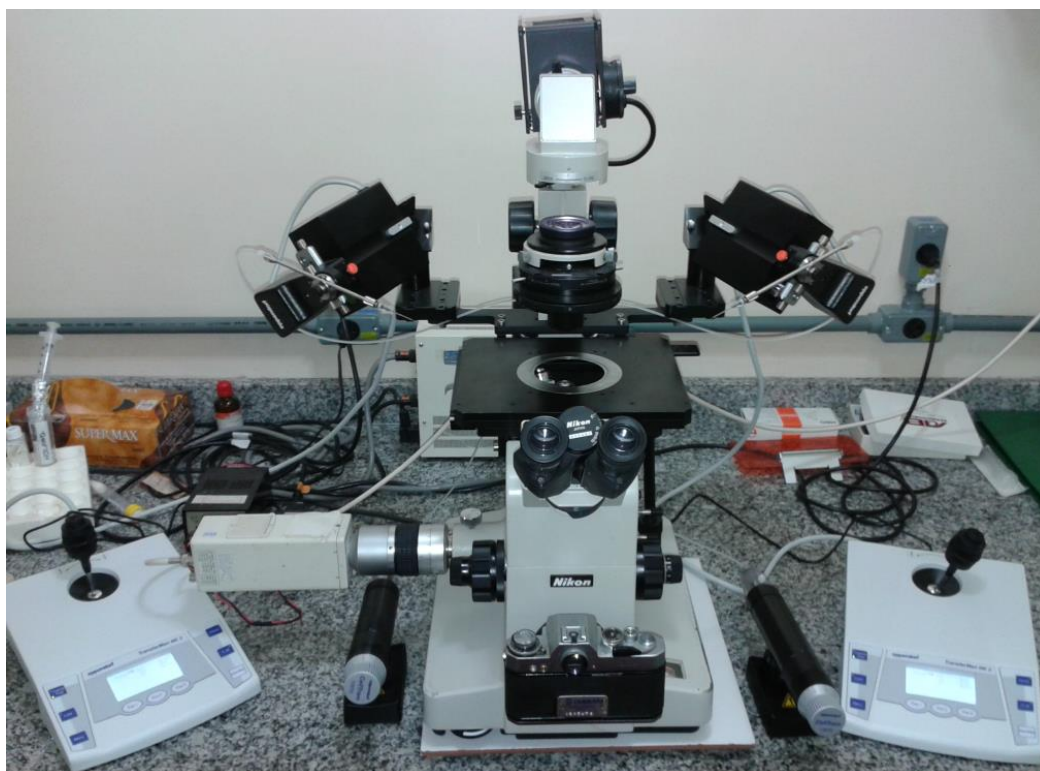
FIGURA 3 – Micromanipulador (Fonte: arquivo pessoal).
