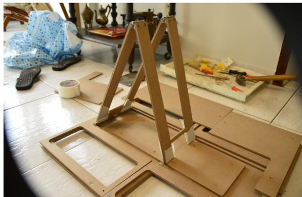
**Figura 56 - Montagem do suporte em camadas**
