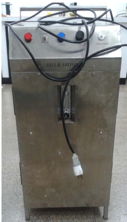
Figura 1. Gerador de ozônio baseado no método de Descarga por Barreira Dielétrica.
