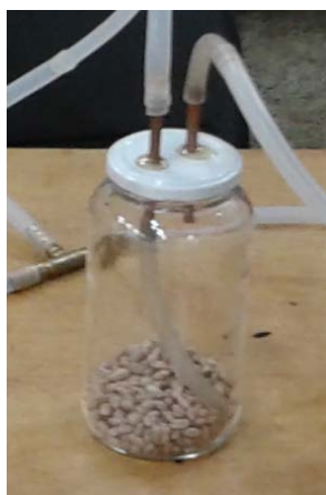
Figura 2. Recipiente de vidro adaptado à passagem de ozônio e usado para estimativa do tempo letal do gás.
