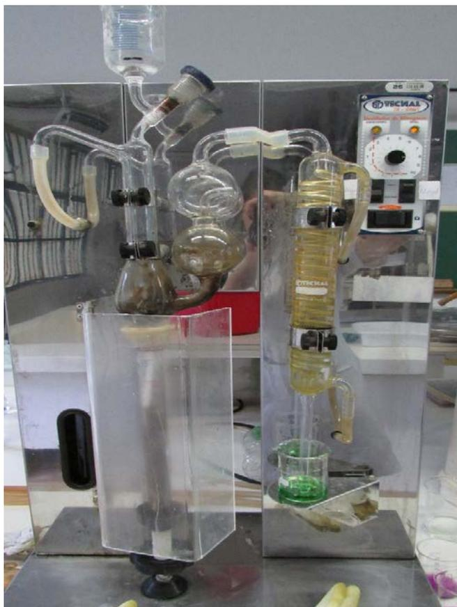
Figura 11: Destilador de proteína em funcionamento, coleta da solução de coloração esverdeada.
