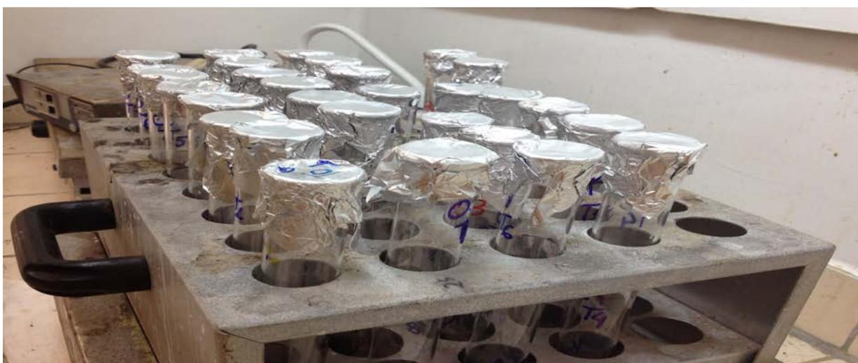
Figura 10: Bloco digestor na capela, aguardando o início da digestão.
