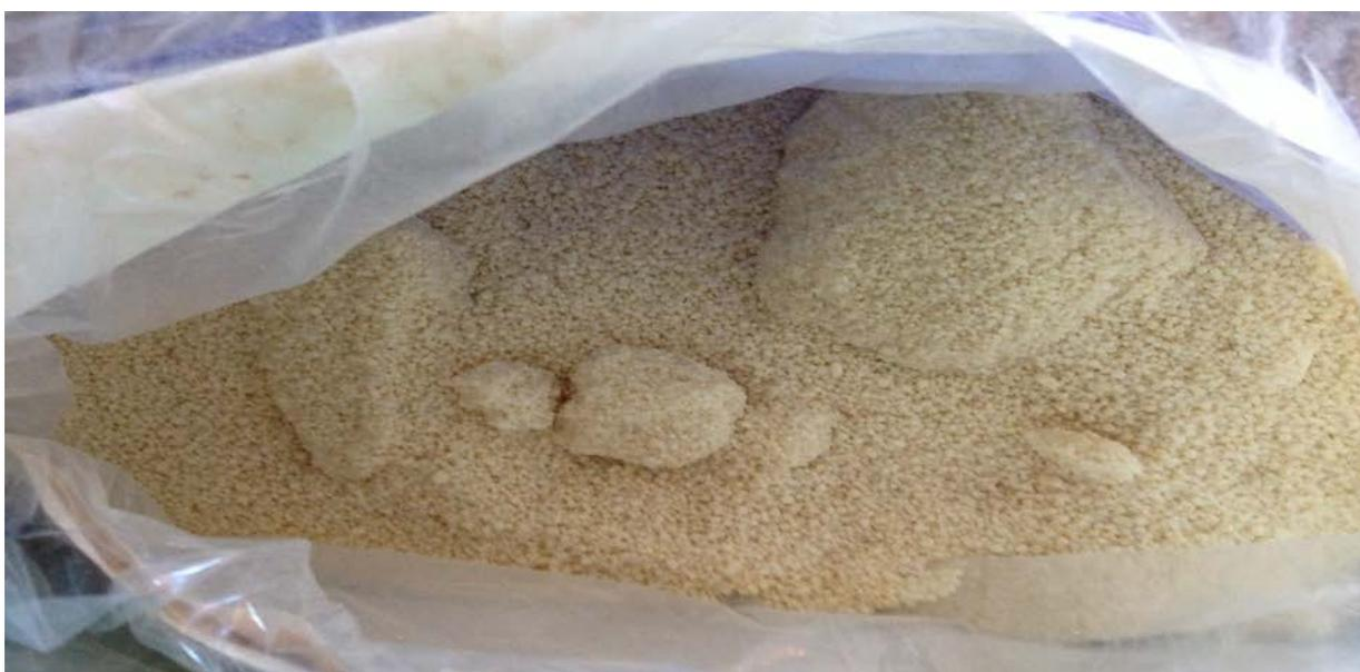
Figura 16: Empedramento devido ao armazenamento do Reforce N revestido, produto no saco.
