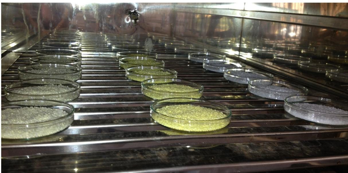
Figura 6: Placas com amostras na estufa a 50°C.
