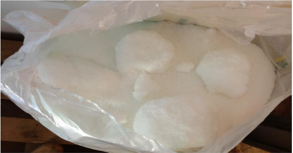
Figura 17: Empedramento devido ao armazenamento do Reforce N sem revestimento, produto no saco.
