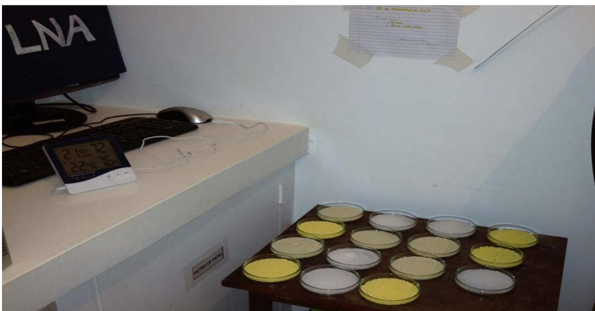
Figura 7: Monitoramento da temperatura e umidade do ar pelo termo-higrômetro.
