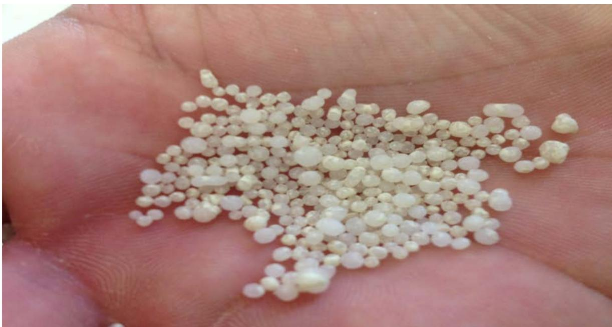
Figura 15: Revestimento desuniforme Reforce N revestido.
