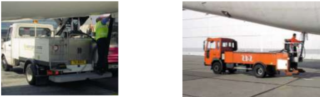
Figura 2.9: Processo de abastecimento de água potável [16].
