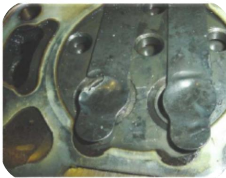
Figura 4. 2 - Palhetas danificadas por golpe de líquido - Bassetto (2009)
