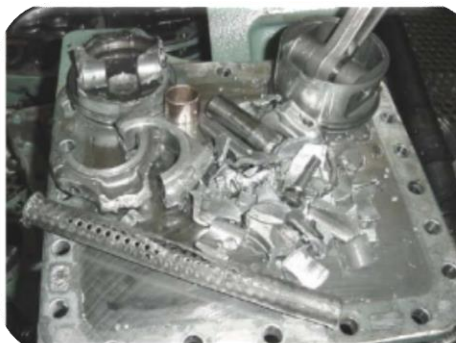
Figura 4. 3 - Danos resultantes de um golpe de líquido - Bassetto (2009)
