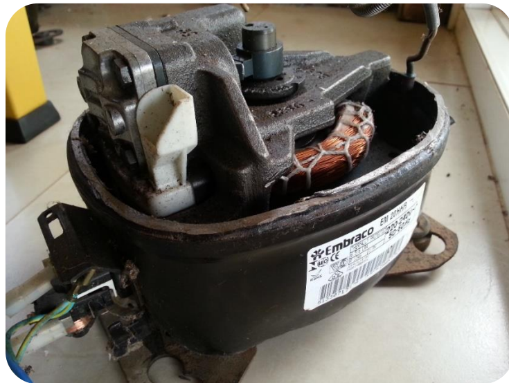
Figura 5. 8 - Compressor de refrigeração aberto
