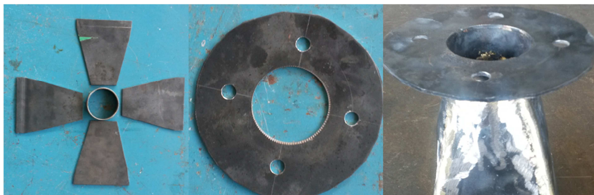
Figura 5.7 - Processo de montagem da conexão do gerador ao escapamento
