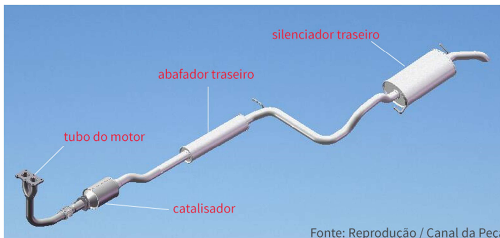
Figura 2. 7 - Esquema detalhado do funcionamento de um escapamento. (Canal da Peça, 2014)
