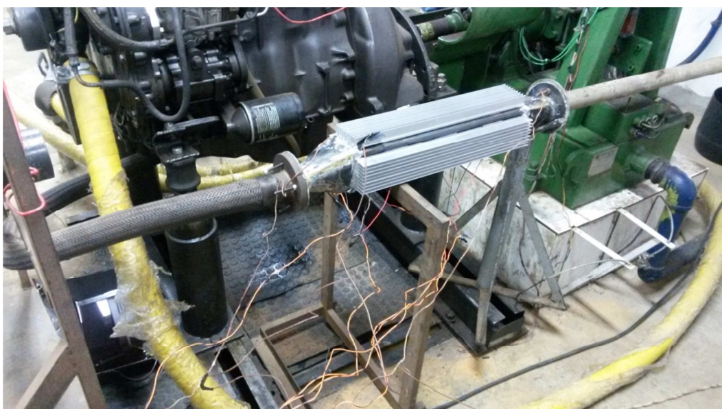
Figura 5. 11 - Sistema gerador acoplado ao tubo de escape do motor diesel para execução dos testes
