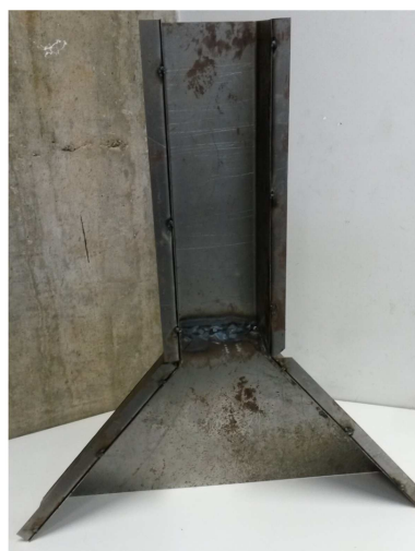
Figura 5.3 - Bocal convergente fabricado em aço 1020
