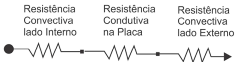
Figura 3. 4 - Resistência térmica equivalente do sistema
