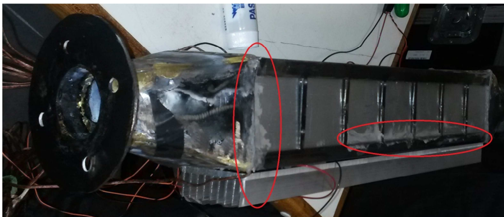
Figura 5.12 - “Veda escape” aplicado no gerador durante sua montagem
