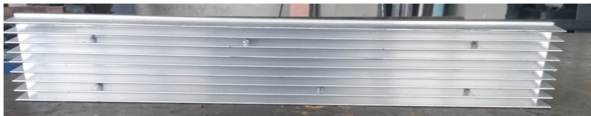
Figura 5. 4 - Aleta de alumínio já cortada e furada de acordo com as especificações do projeto
