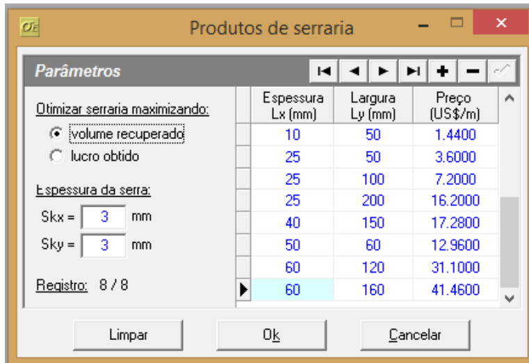
Figura 3: Parâmetros da otimização de produtos para serraria demonstrados no software SigmaE.
